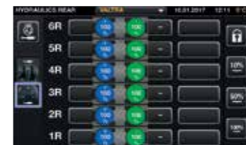
Galite priskirti bet kokį valdiklį bet kokios hidraulinės funkcijos, įskaitant priekinius ir galinius hidraulinis vožtuvus, priekines ir galines jungtis bei priekinį krautuva, valdymui.
