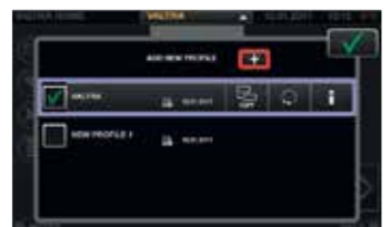
Profiliai operatoriams ir padargams, kuriuos galima lengvai pakeisti iš bet kurio ekrano meniu. Visi nustatymų pakeitimai bus išsaugoti pasirinktame profilyje.
